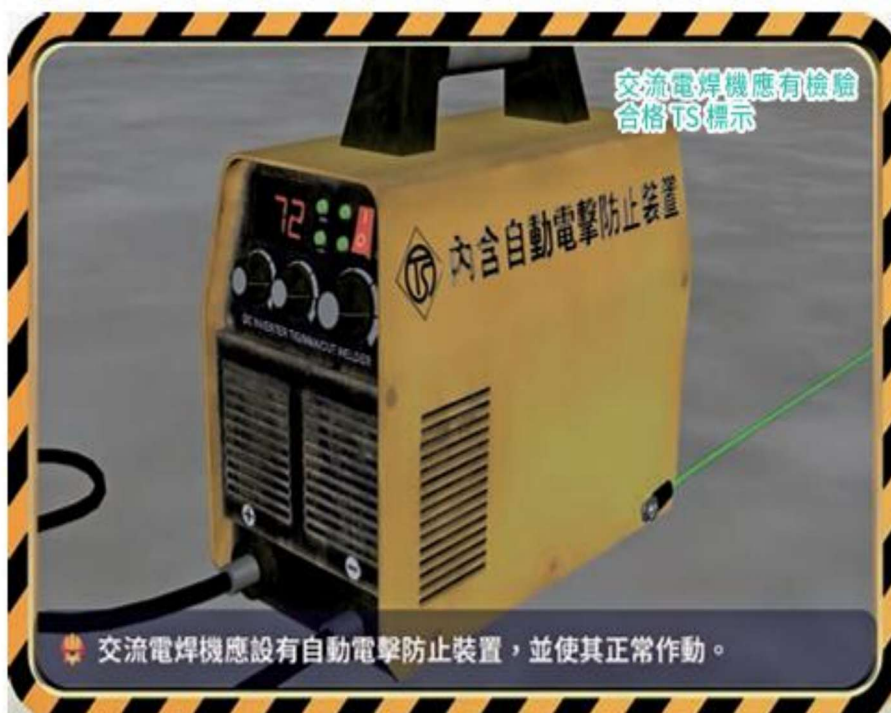
圖 28 內含自動電擊防止裝置交流電焊機示意
