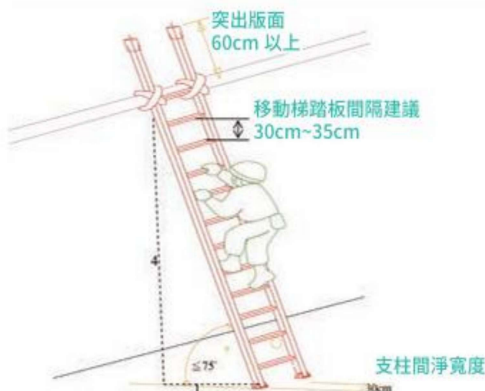
圖 7 使用移動梯之參考例 (高度 2 公尺以上建議搭配安全母索及全身背負式安全帶使用)
