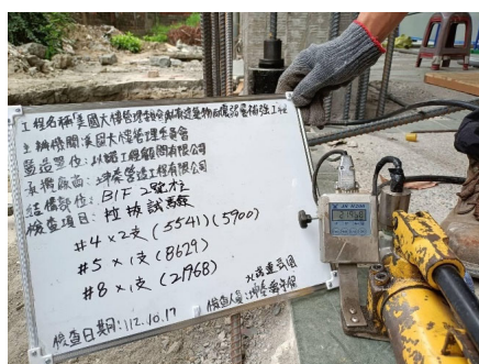
植筋拉拔試驗
