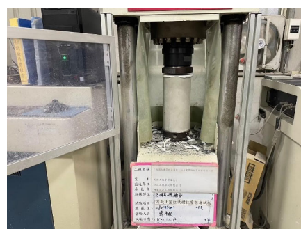
混凝土試體抗壓試驗
