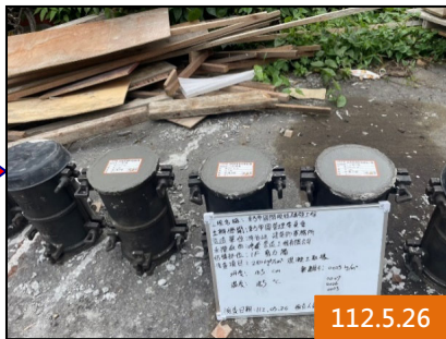
混凝土試體製作
