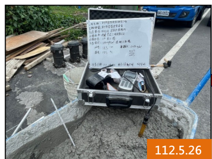
混凝土氯離子及溫度
