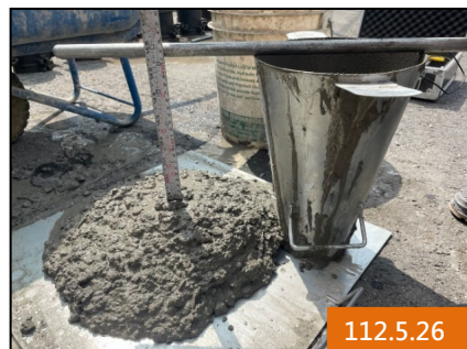
混凝土測量坍度
