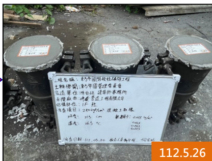
製作混凝土試體
