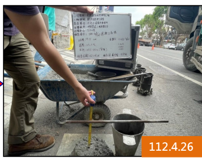
混凝土測量坍度
