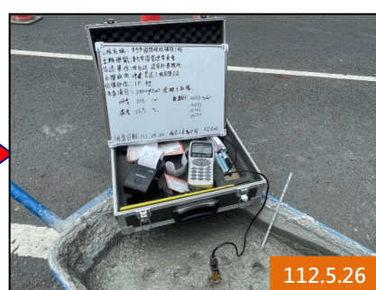
混凝土測量溫度及氯離子
