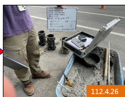
混凝土測量溫度及氯離子
