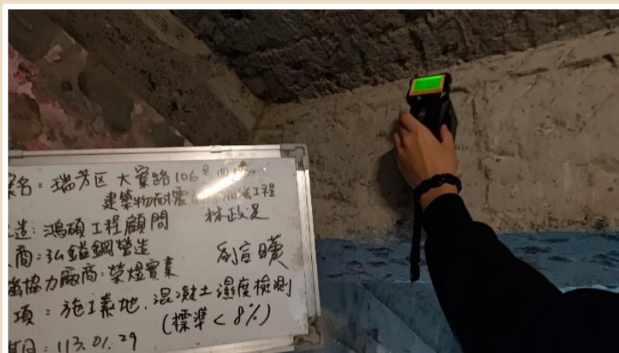
圖17 天花板混凝土濕度檢測
